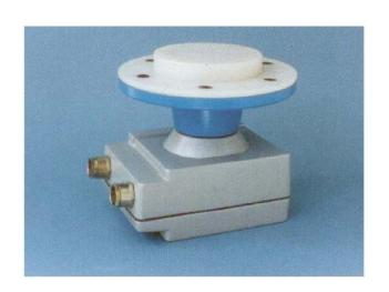
دستگاههای Level Switch از نوع خازنی به منظور کنترل سطح، برای مواد با ضریب دی الکتریک 1.6 <u>1.6 این این استفاده می باشند. با توجه به امکان تنظیم می</u>زان حساسیت در دامنه ای وسیع، از این دستگاه می توان برای صنایع مختلف در مخازن پودر و گرانول و همچنین مایعات استفاده نمود. این کنترلر سطح دارای اتصال فلانجی با پوشش عایق بوده و محل نصب آن از دیواره جانبی سیلو و مخازن می باشد.
